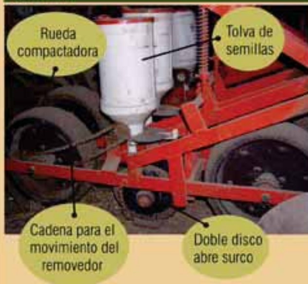
Sembradora "Storerco". Vista del cuerpo de siembra (Fuente: PHR)
