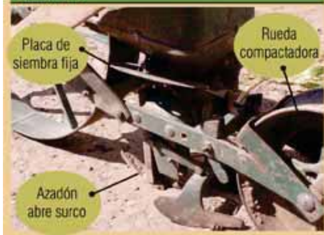
Sembradora Planet Manual. Vista de la placa de siembra fija (Fuente: PHR)
