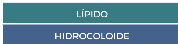
Modelo de película compuesta tipo laminada. Adaptado de Mendoza, 2009.
