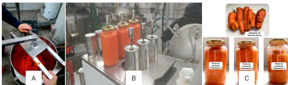
Figura 20. Ensayo de preparación de pasata base de zanahoria. A. preparación en molinillo coloideal; B. envasado; C. tratamientos
